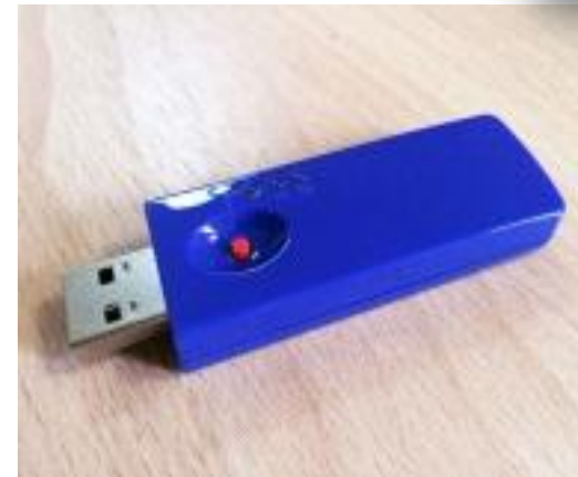
Ресивер для специальной беспроводной компьютерной клавиатуры
