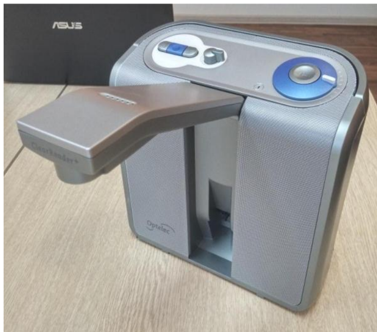
Машина сканирующая и читающая текст Optelec ClearReader+
