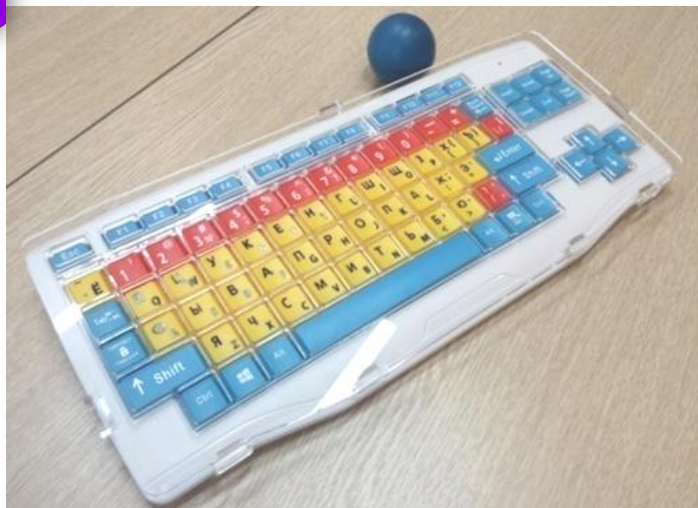
Клавиатура адаптированная с крупными кнопками, пластиковая накладка, разделяющая клавиши, беспроводная
