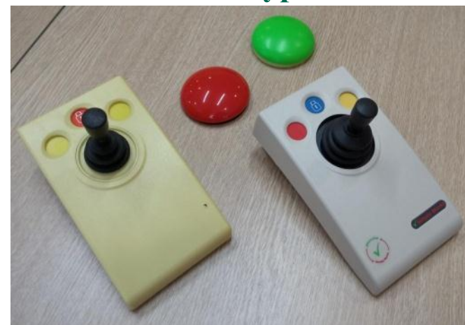
Джойстик компьютерный адаптированный и выносная компьютерная кнопка
